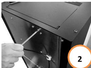
Dévisser les deux vis positionnées à l'arrière du poêle avec un tournevis cruciforme. (Photo N° 2)
