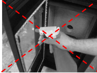
Figure 29 – Nettoyage incorrect de la vitre
