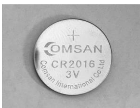
Figure 17- Batteries de télécommande
