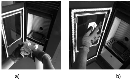
Figure 30 – Nettoyage de la vitre : a) appliquez du liquide sur le chiffon ; b) nettoyez la vitre avec le chiffon
