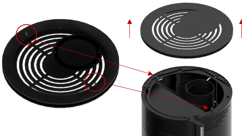
Figure 10 - Démontage du dessus en tôle
