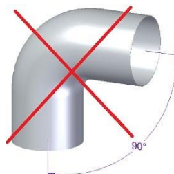
Figure 43 - Pente incorrecte pour les virages
