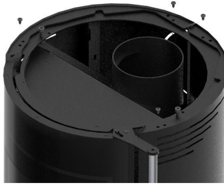
Figure 14 - Montage des capots latéraux sur l'équipement
