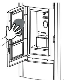
**3) NETTOYAGE DE LA VITRE :** pour nettoyer la vitre, utilisez un chiffon non pelucheux avec notre nettoyant CLEAN GLASS ou un nettoyant spécifique pour poêles et cheminées.
